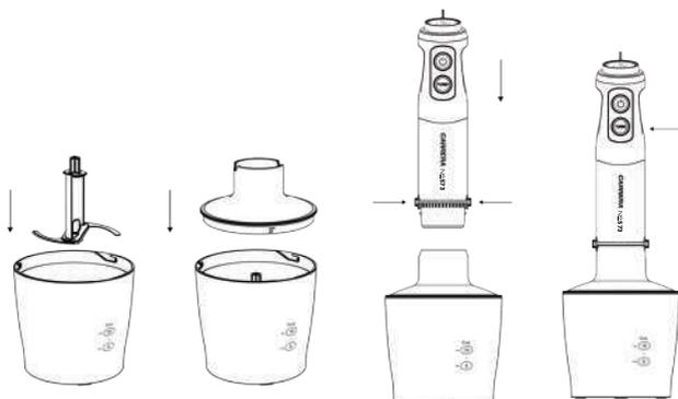
После использования отключите прибор от сети, затем отсоедините от крышки измельчителя корпус. Снимите крышку и осторожно извлеките нож - после этого выложите измельченные продукты.
