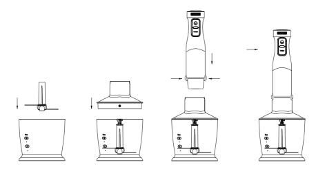
После использования отключите прибор от сети, затем отсоедините от крышки измельчителя корпус. Снимите крышку и осторожно извлеките нож - после этого выложите измельченные продукты.
